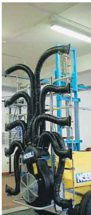
Prova di laboratorio per il rilievo della velocità dell'aria su macchine irroratrici/Laboratory test to determine airflow through a sprayer
